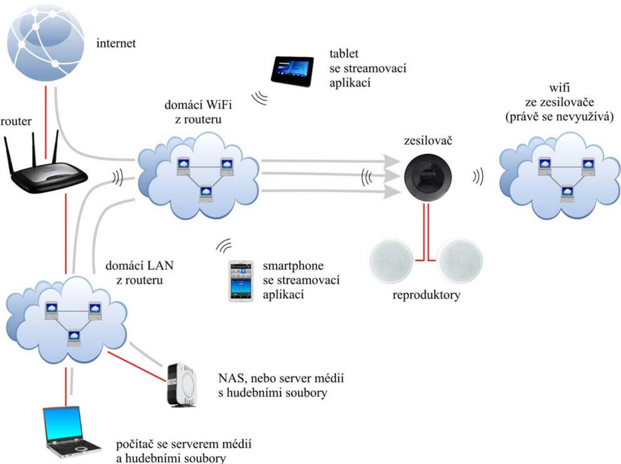
Výše uvedený obrázek ukazuje, jak streamování probíhá a co vše je možné k tomuto využít. Základem je LAN nebo WiFi síť do které máme přihlášený zesilovač s vestavěným WiFi modulem.
